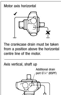
Standard drain port <sup>3</sup>/4" - 16 UNF 0,35 bar (5 psi)
